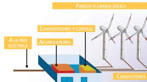
DIAGRAMAS DE FUNCIONAMIENTO DE UN AEROGENERADOR Y DE UN PARQUE EÓLICO.
